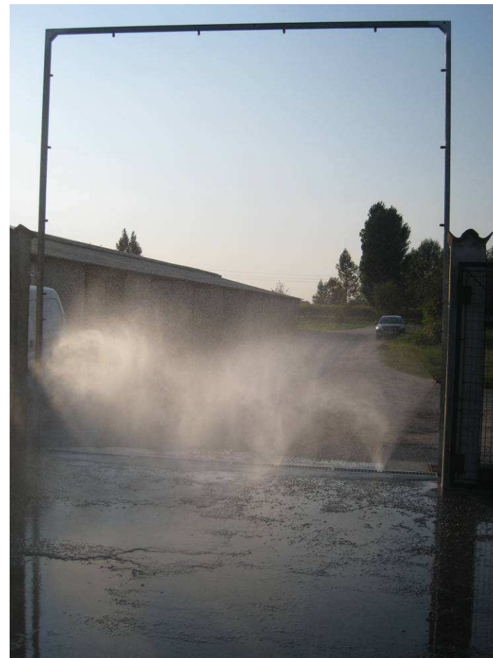
Arco di disinfezione in funzione 2
